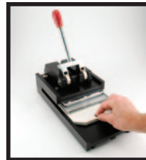
2. Slide die under cutter platen.
